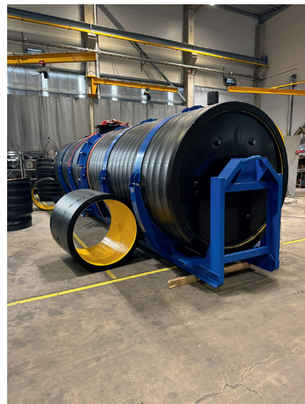
2 pav. Kilnojamojo vandens rezervuaro gamybos etapas
