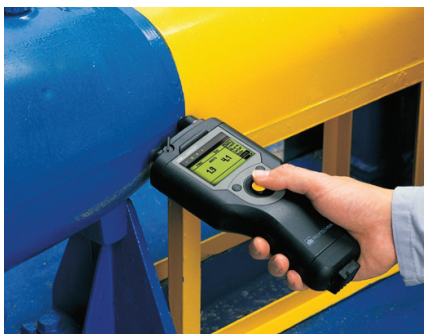
1 pav. Siurblių vibracijų matavimas
