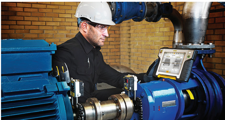
6 pav. Šiuolaikiniais ašių lygiavimo prietaisais galima daug greičiau ir tiksliau atlikti darbus
