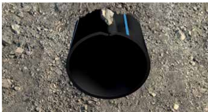
PE100 ar PE80 vamzdžių taškinio pažeidimo pavyzdys
