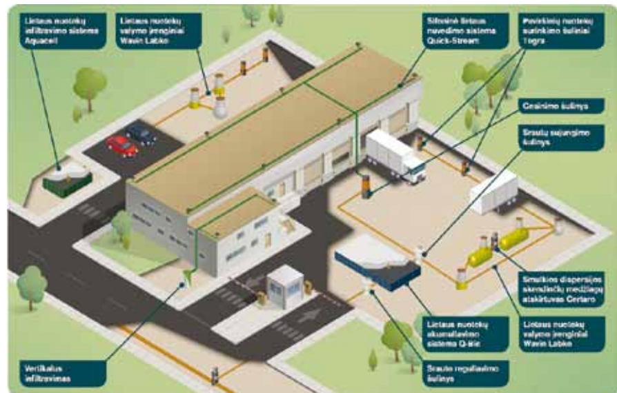
Pav. Efektyvus sprendimas surenkant, transportuojant, valant, infiltruojant/kaupiant perteklinio lietaus nuotekas pagal „Wavin“ Intesio koncepsiją
