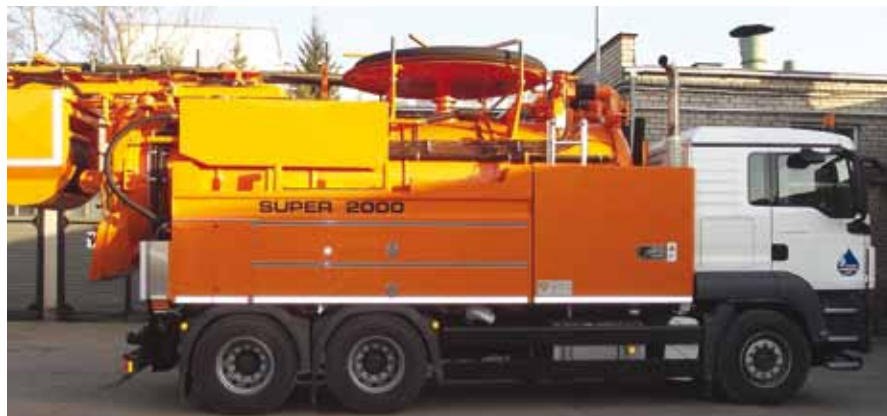
Pav. Asenizacinis (hidrodinaminis) automobilis MAN TGS 33.440 su įranga Super 2000 tipas 10,0/6,0
