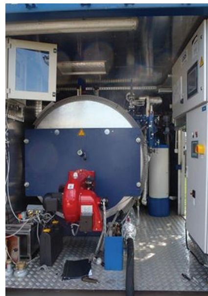
1 pav. Garo turbina gamina vamzdžio šildymui sočiuosius garus, o vamzdžio priėmimo gale garas ir susikondensavęs vanduo saugiai išleidžiami per kondensato rinktuvą
