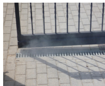
2 pav. Į gatvės buitinių nuotekų tinklus paleisti dūmai veržiasi pro gyventojų lietaus surinkimo mazgo trapą
