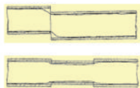
1 pav. Kai kuriuose ruožuose Compact Pipe vamzdis nebeatgaus apskritos formos. Šiuos ruožus galima išplėsti panaudojant tinkamus kalibrus arba frezavimu
