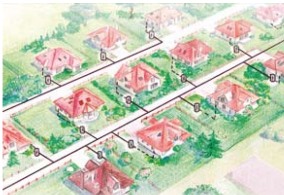
1 pav. Slėginė nuotekų sistema su prie kiekvieno namo pastatyta individualia siurbline ir nuo jos einančiais slėginiais vamzdžiais
