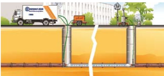
2 pav. Įkištas Compact Pipe vamzdis šildomas į jį tiekiamu sočiuoju garu; vamzdžiui atgavus savo pradinį skerspjūvį, į jį patekęs šaltas suslėgtas oras aušina vamzdžio sienelę
