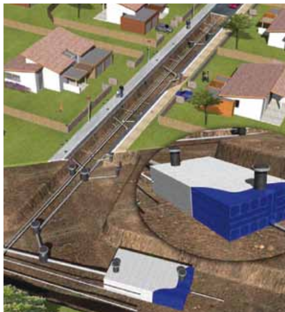
Pav. Perteklinio lietaus nuotekų kiekio tvarkymo sprendimas, panaudojant kaupimo sistemą urbanizuotose teritorijose
