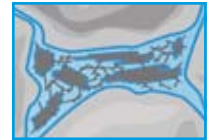
5 pav. Ženklus porų erdvės ir mikrotrūkių sumažėjimas
