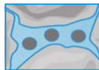
2 pav. Kvarcinio smėlio miltelių įterpimas tarp cemento dalelių laisvoje porų erdvės vandens dalyje
