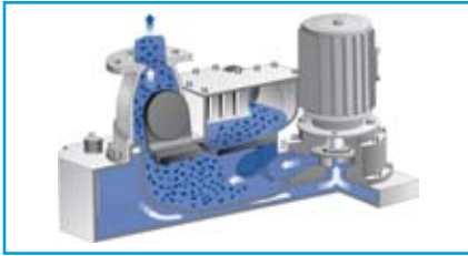
7 pav. Nuotekų pumpavimo procesas
