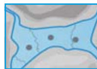
3 pav. Porų gelio susitraukimas ir mikrotrūkių susidarymas
