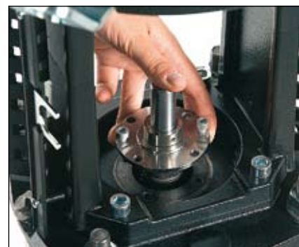
5 pav. Helix siurblio mechaninį sandariklį paprastai išimti ir pakeisti su visu patronu
