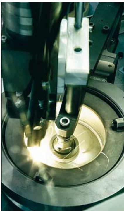
2 pav. Helix siurblio darbaračiai gaminami naudojant lazerines technologijas
