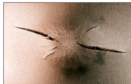
4 pav. Vidinė vamzdžio sienelė, iš išorės paveikta taškiniu krūviu. Matyti akivaizdus įtrūkimas
