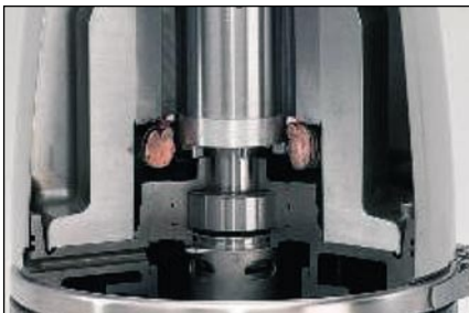
3 pav. Aliuminio ašis eliminuoja vėsinimo skysčio poreikį, todėl visi SE siurbliai vienodai tinkami naudoti šlapioje ir sausoje aplinkoje
