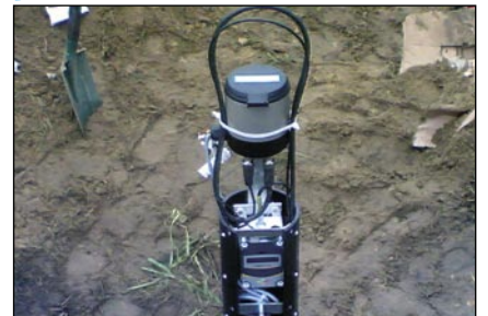
4 pav. Matavimo keitiklis sukomplektuotas su GSM modemu (abu prietaisai maitinami baterijomis)
