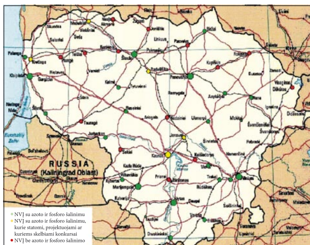
1 pav. Azoto ir fosforo šalinimas iš nuotekų Lietuvos miestuose
