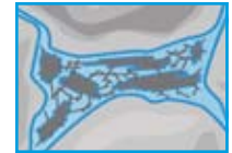
5 pav. Ženklus porų erdvės ir mikrotrūkių sumažėjimas
