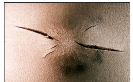
4 pav. Vidinė vamzdžio sienelė, iš išorės paveikta taškiniu krūviu. Matyti akivaizdus įtrūkimas
