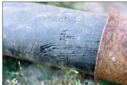
2 pav. Vamzdis su išilginiais įbrėžimais
